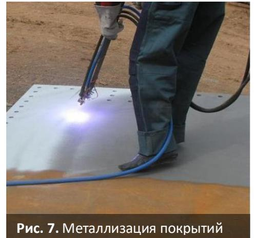
Рис. 7. Металлизация покрытий
