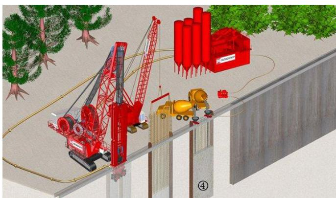
**Рис. 20.** Устройство монолитных конструкций по методу «стена в грунте»
