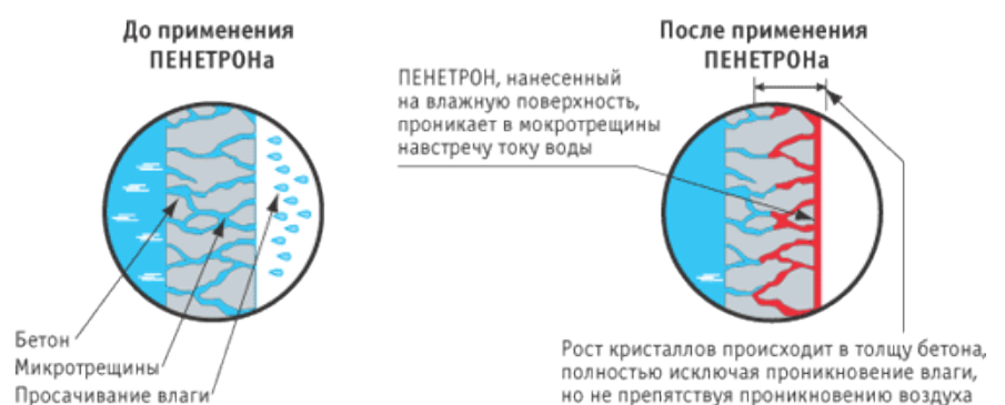
Рис. 6. Механизм действия проникающей гидроизоляции
